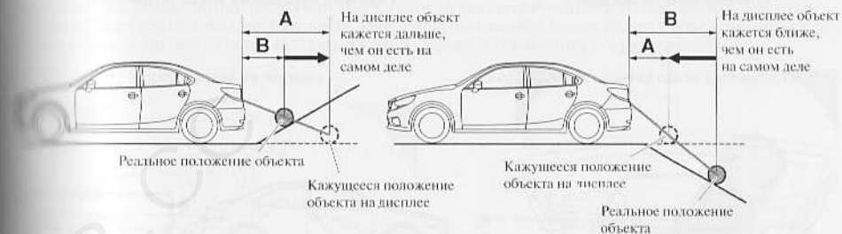
Искажение расстояния между автомобилем и объектом на дисплее Реальное расстояние между автомобилем и объектом
